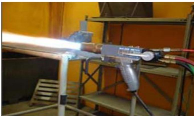
Figura 2 - Pistola de aspersão térmica a chama utilizando arame
