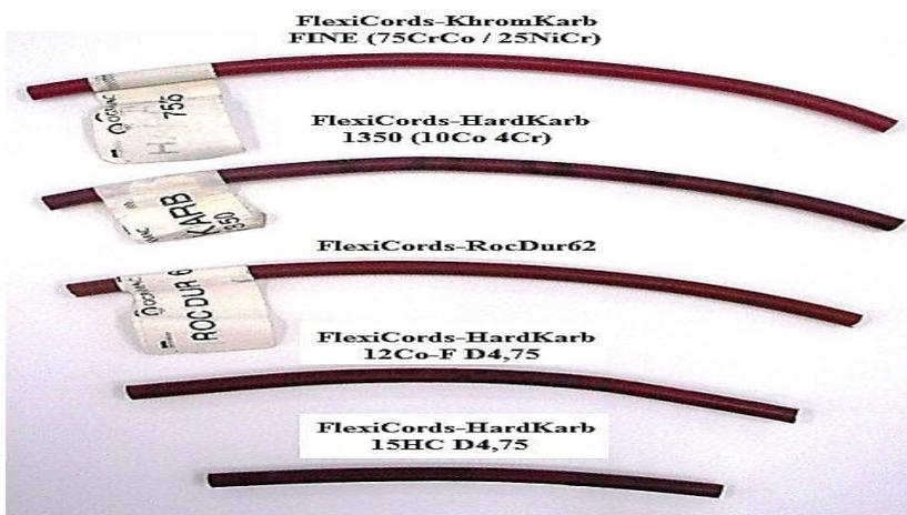
Figura 15- Materiais para depositados na forma de cordões flexíveis.
