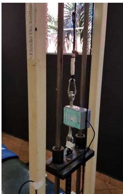
Figura 5. Posicionamento da célula de carga no equipamento mesa flexora.
