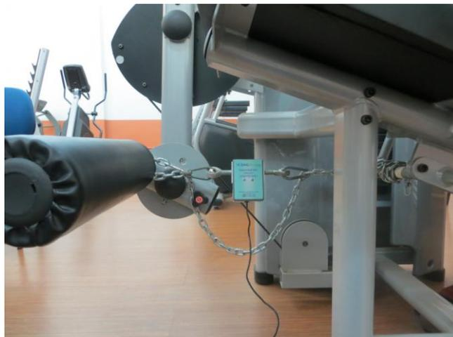
**Figura 1.** Posicionamento da célula de carga na cadeira extensora.
