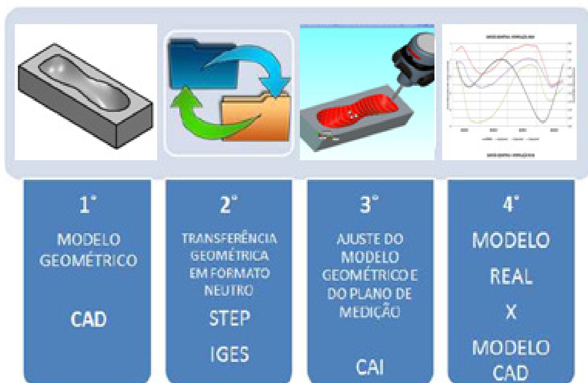
FIGURA 25: PROCEDIMENTO PARA MEDIÇÃO DOS CORPOS DE PROVA
