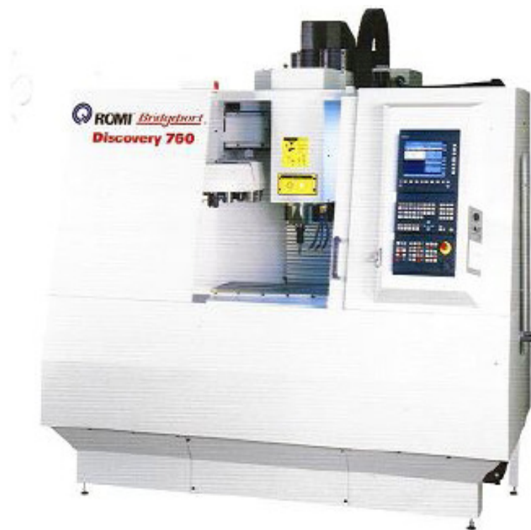
FIGURA 23: CENTRO DE USINAGEM VERTICAL, MODELO DISCOVERY 760, FABRICADO PELAS INDÚSTRIAS ROMI S.A
