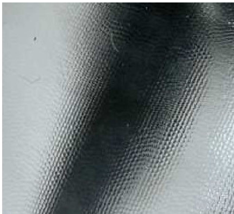
FIGURA 36: ASPECTO SUPERFICIAL CORPO DE PROVA USINADO COM A INTERPOLAÇÃO LINEAR.
