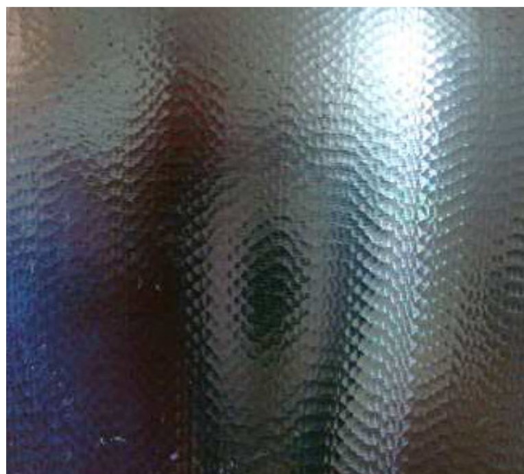
FIGURA 37: ASPECTO SUPERFICIAL CORPO DE PROVA USINADO COM A INTERPOLAÇÃO SPLINE.
