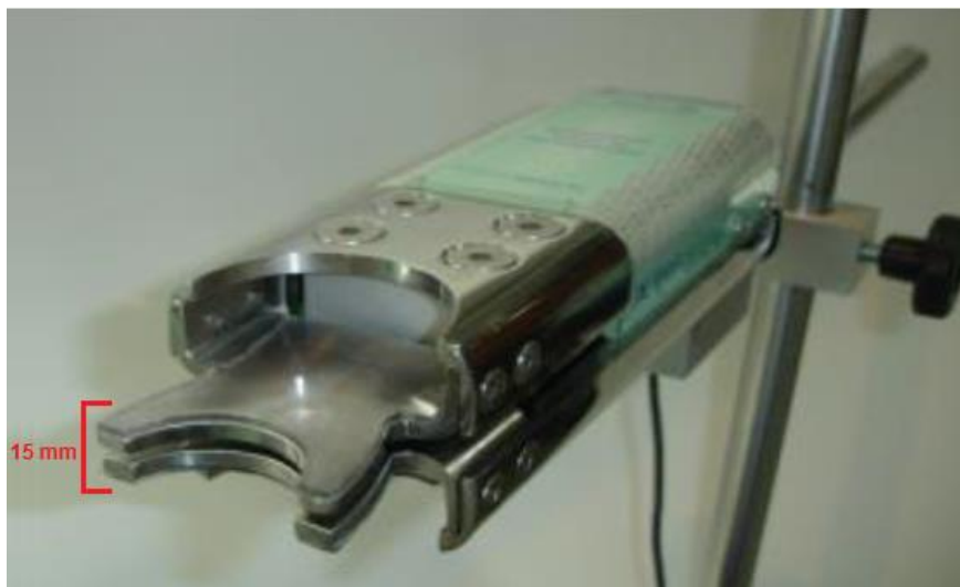
Figura 2 – Dinamômetro de mordida.
