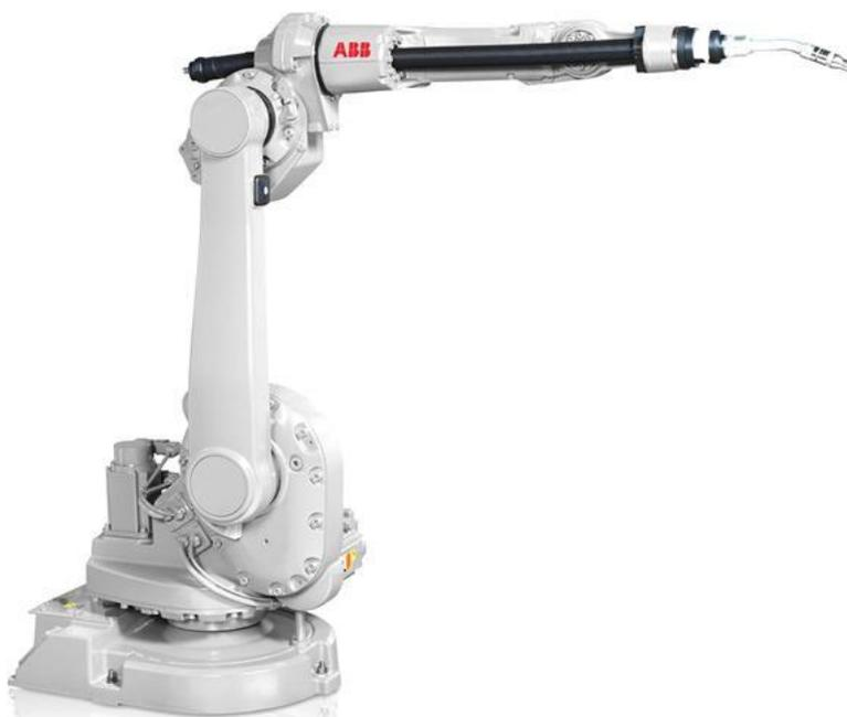
Figura 2.15: Robô ABB IRB 1600ID destinado a Soldagem [30]
