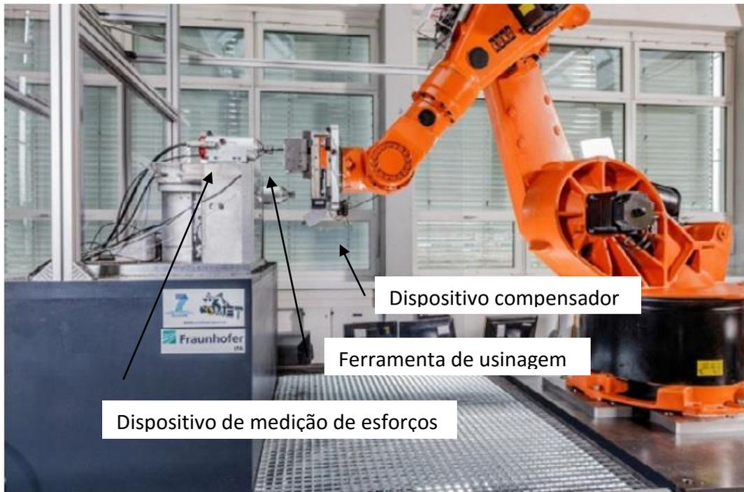
Figura 2.18: Robô e seu dispositivo para compensação de erros durante a usinagem [34]
