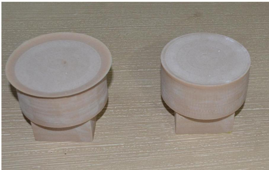
Figura 5.44: Corpo de prova A, com e sem rebarba
