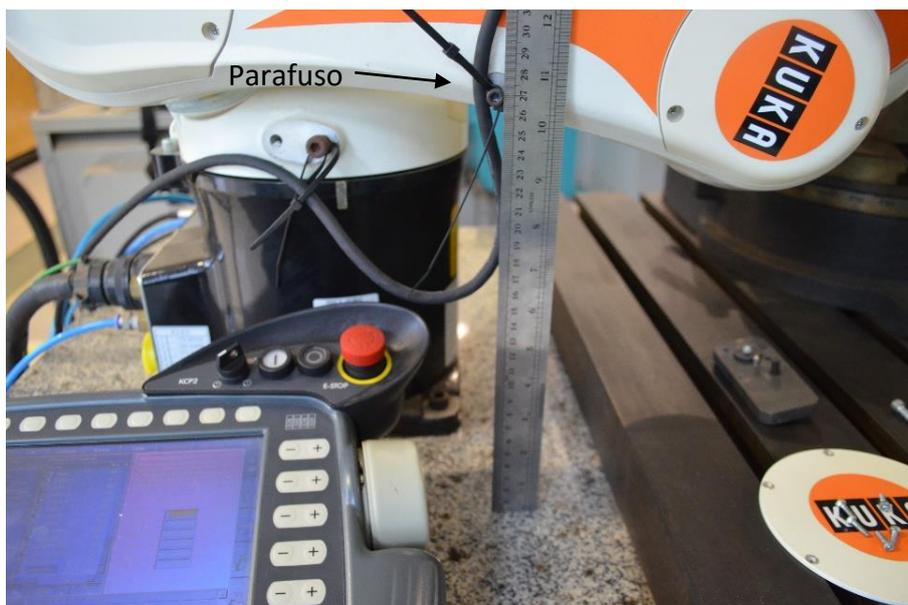
Figura 8.8: Posicionamento do eixo 2 do robô. Figura B
