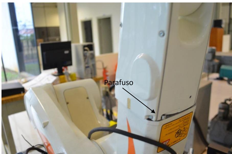
Figura 8.13: Posicionamento do eixo 4 após a colocação do parafuso de masterização.
