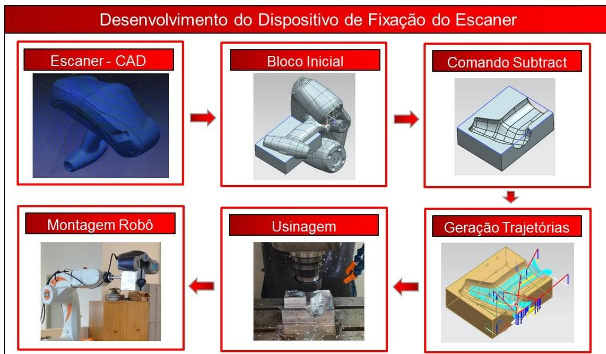
Figura 5.5: Imagens sequenciais do desenvolvimento e fabricação do dispositivo de fixação do escaner
