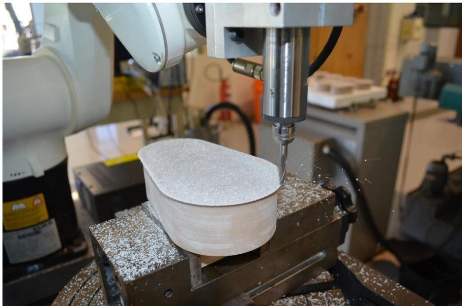
Figura 5.43: Corpo de prova B – Processo de rebarbação
