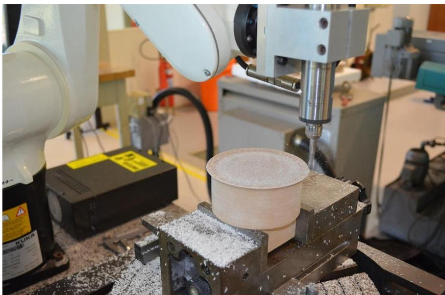
Figura 5.42: Corpo de prova A – Processo de rebarbação
