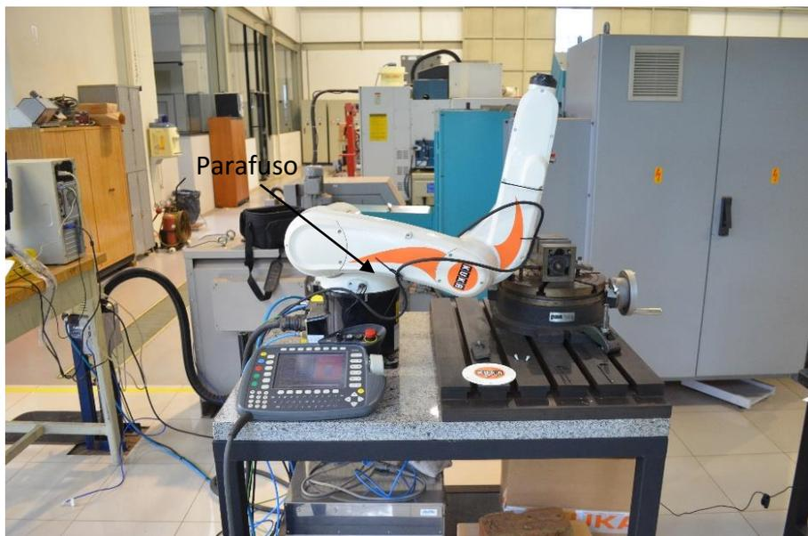
Figura 8.7: Posicionamento do eixo 2 do robô. Figura A
