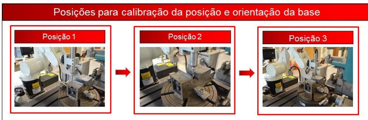
Figura 5.12: Sequencia de posições para a calibração da base
