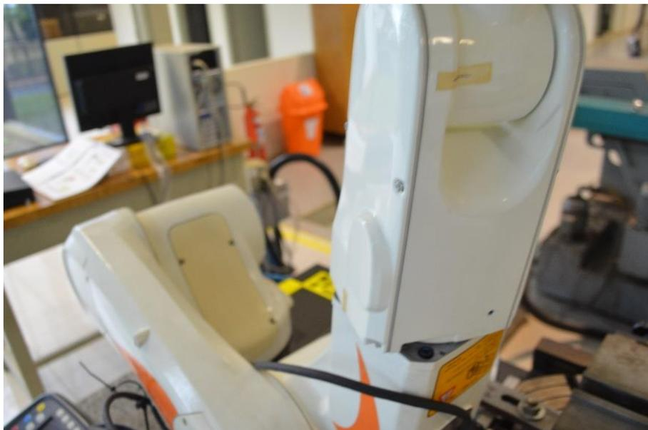
Figura 8.12: Posicionamento do eixo 4 para a colocação do parafuso de masterização.
