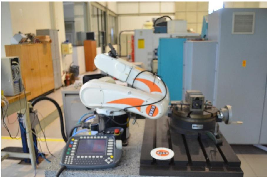
Figura 8.18: Posicionamento dos eixos para a masterização
