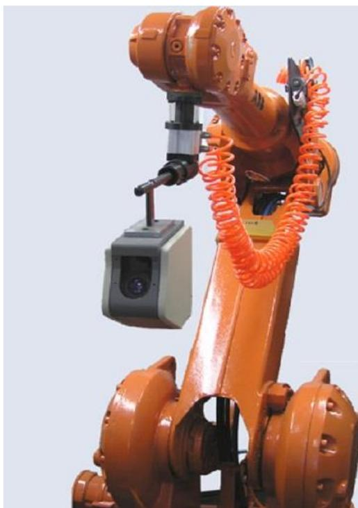
Figura 2.35: Ilustração do escaner portátil fixado ao robô [44]
