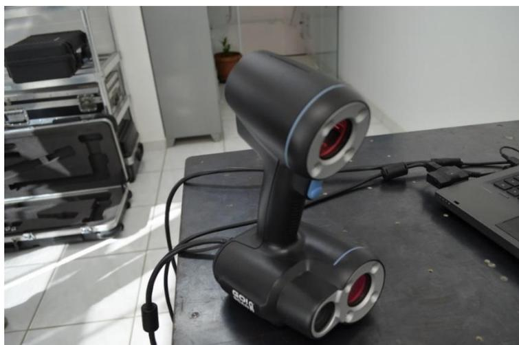
Figura 5.2: Go Scan. Equipamento usado para escanar a ExaScan
