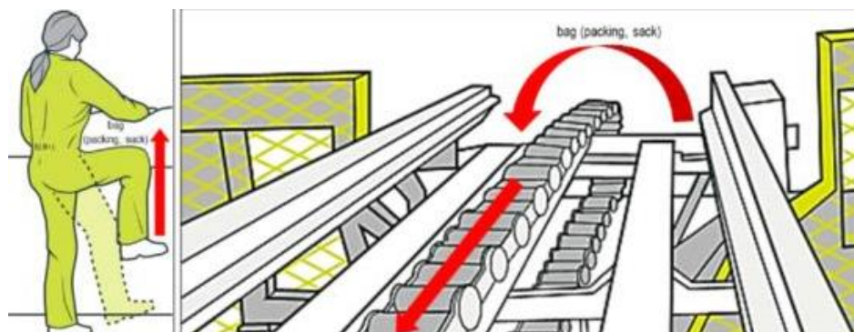
FIGURA 12: EXEMPLO DE USO DE ESTEIRAS MOVIDAS POR CORRENTES PARA SACOS E EMBALAGENS DE VEGETAIS. FONTE: (MAŠÍN 2016).
