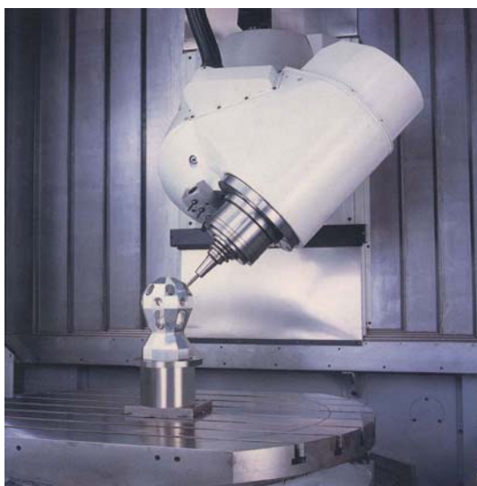
Figura 2.5: Exemplo de máquina-ferramenta com eixo C localizado na mesa [20].
