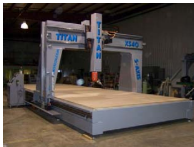
Figura 2.4: Máquina-ferramenta com 5 eixos do tipo pórtico [19].
