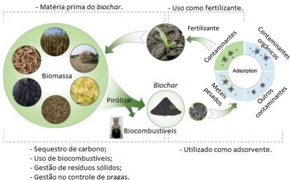
Figura 25 – Os benefícios da aplicação do biochar como alternativa no tratamento de efluentes (adaptado de TAN et al. , 2015).
