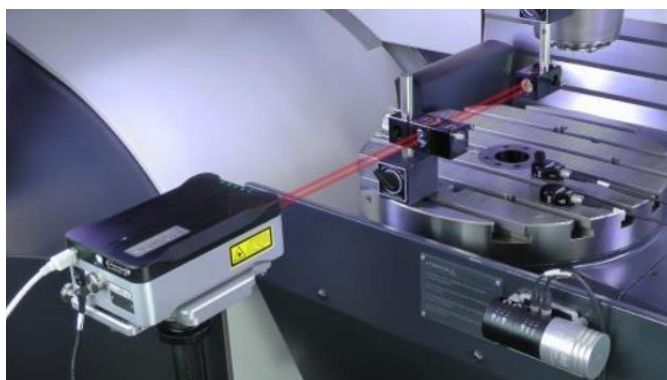
Figura 30 - Interferômetro laser Renishaw XL-80. Fonte: RENISHAW (2018c), acesso em: 15 fev. 2018.
