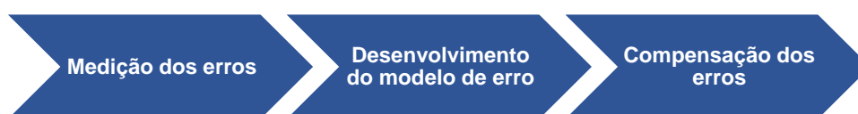
Figura 13 - Etapas para compensação de erros geométricos. Fonte: HSU; WANG (2007)
