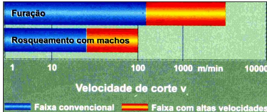
*FIGURA 5 - FAIXAS DE VELOCIDADE DE CORTE PARA USINAGEM HSC EM FURAÇÃO E EM ROSQUEAMENTO COM MACHOS*
