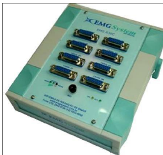
Figura 1: Módulo de aquisição de sinais EMG 830C (EMG System do Brasil).
