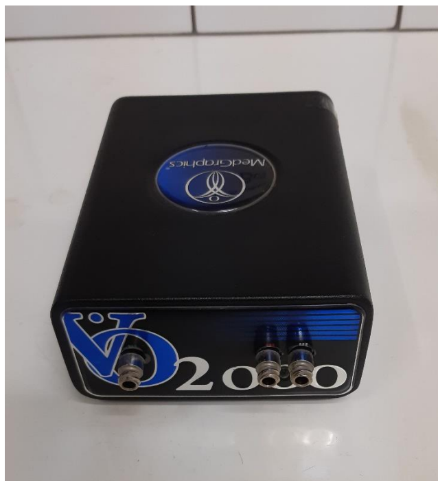
Figura 4. Mostra o analisador de gases expirados ( Medical Graphics ® VO2000) utilizado no teste incremental máximo.
