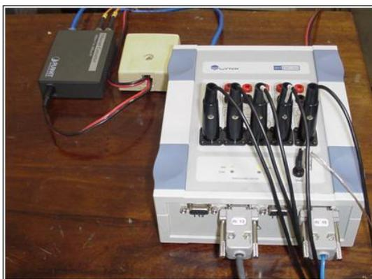
**Figura 4** – Módulo de Aquisição de Sinais (modelo EMG 1000 da Lynx®).
