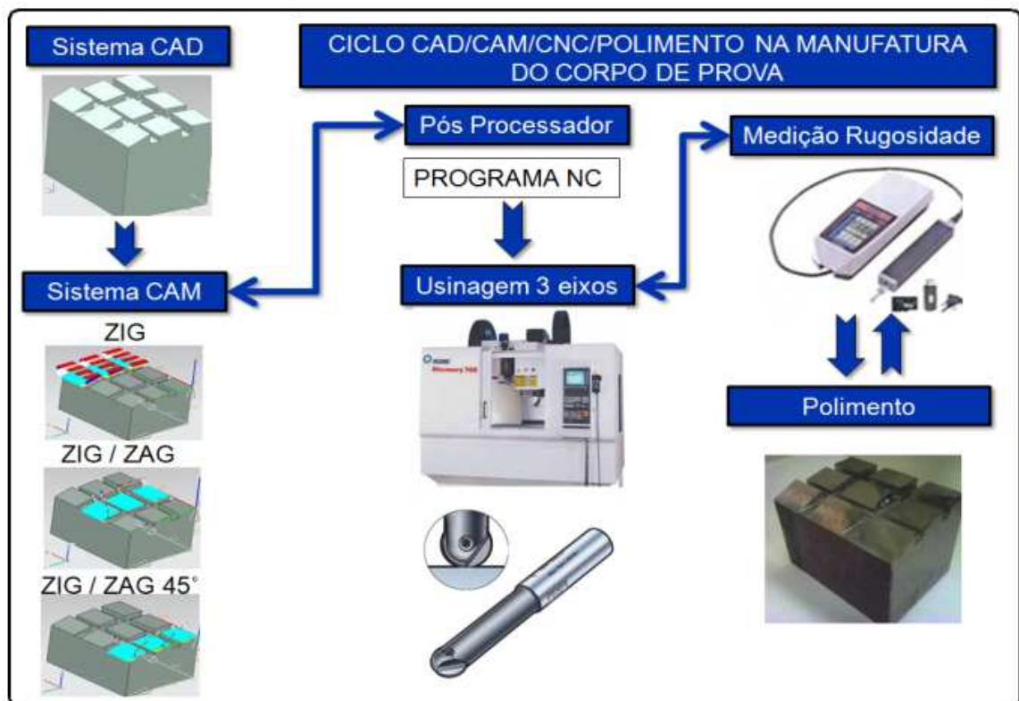
Figura 24: Método para manufatura do Corpo de Prova dos ensaios preliminares.
