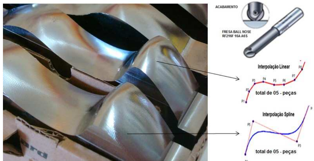
Figura 29: Acabamento dos Corpos de Prova utilizando fresa ball nose e com duas Interpolações (linear e spline).
