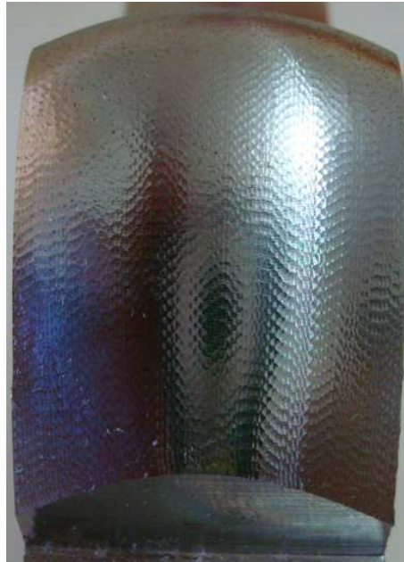
Figura 40: Acabamento superficial do corpo de prova com interpolação spline
