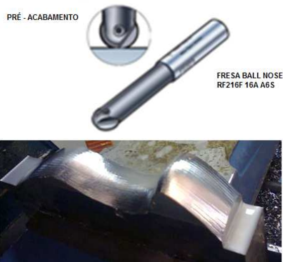
Figura 28: Pré – acabamento do Corpo de Prova utilizando fresa ball nose
