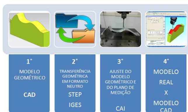
Figura 32: Procedimento de medição do corpo de prova.
