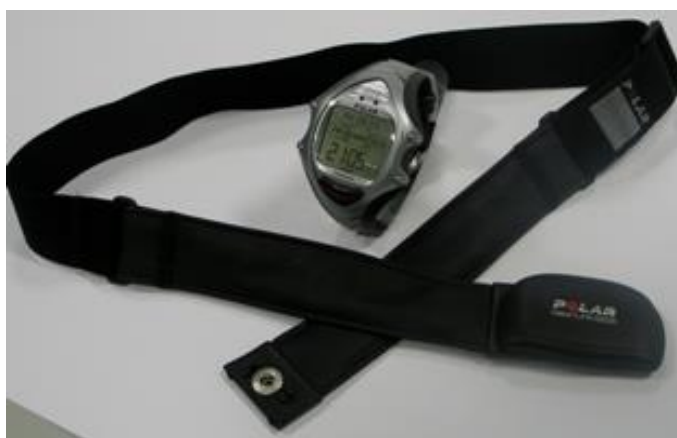
Figura 10: Cardíofrequencímetro Polar modelo RS800cx composto pela faixa com eletrodos na parte interna e o relógio de monitoramento (fonte: Google).
