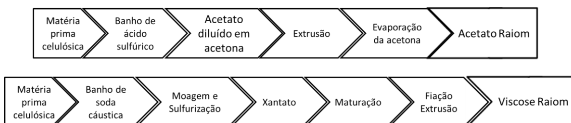
Figura 7. Descrição das etapas do processo produtivo das fibras artificiais (Fonte: adaptado de ABRAFAS, 2014).
