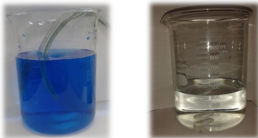
Figura 23. Solução de azul de metileno (a) antes do tratamento e (b) após o tratamento com FVA's preparadas a 500°C.
