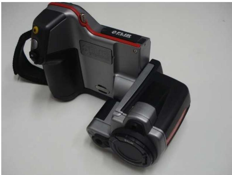
Figura 2 - Termógrafo utilizado para captar as imagens infravermelhas, modelo T360 da marca FLIR® Systems
