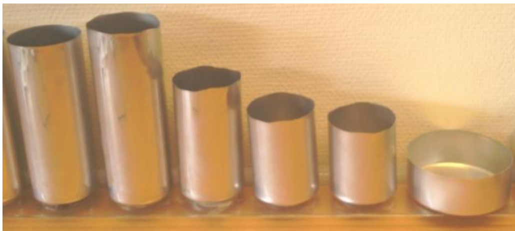
Figura 19 - Progressão na estampagem e formação da parede da latinha Fonte: Adaptado de Eliasson e Modari (2014)
