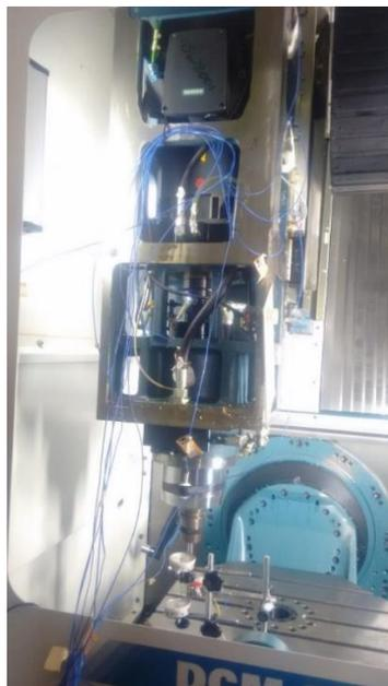
*FIGURA 32: POSICIONAMENTO DOS TERMOPARES E RELÓGIOS COMPARADORES DA MF*
