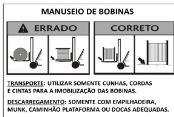
FIGURA 12 - MANUSEIO DE BOBINAS. FONTE: EMPRESA B (2019).
