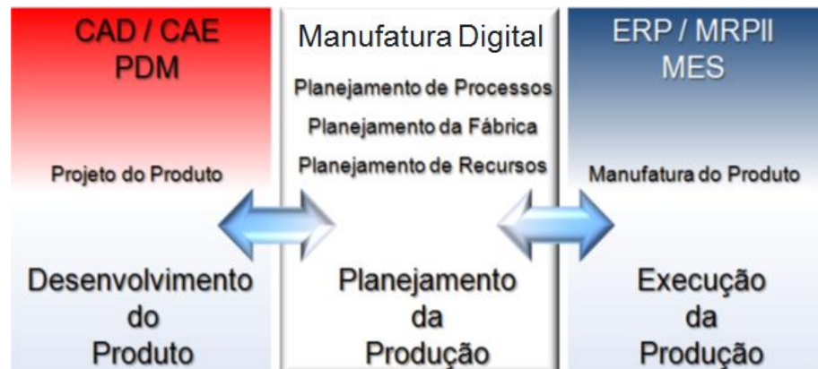
Figura 9 - Integração na Fábrica Digital. Fonte: Adaptado de [60]
