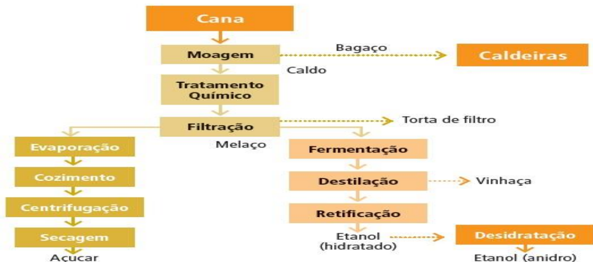
Figura 6 – Fluxograma da Produção de Açúcar e Etanol Fonte: Adaptado de SEABRA (2008).
