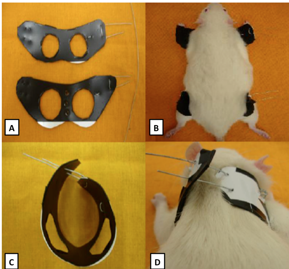
Figura 3 - Dispositivo anterior e posterior (A), ajuste ao corpo do animal (B), sistema de cinta regulável (C e D).
