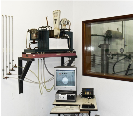
Figura 11: Sistema supervisorio de controle e sistema de controle eletrônico da balança de medição de consumo de combustível.
