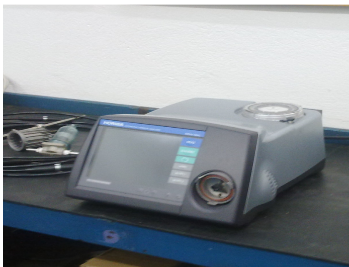
Figura 21: Analisador de emissão automotiva Mod. MEXA-584L.
