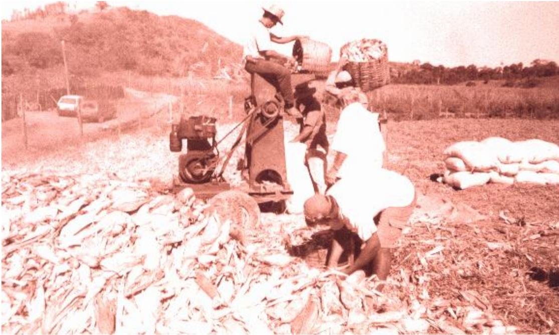
Figura 32: Troca de dia de serviço para beneficiamento do milho no Projeto de Assentamento Chico Mendes. Mão de obra somada ao aluguel de bateadeira adaptada a um motor diesel de 10 cv.
