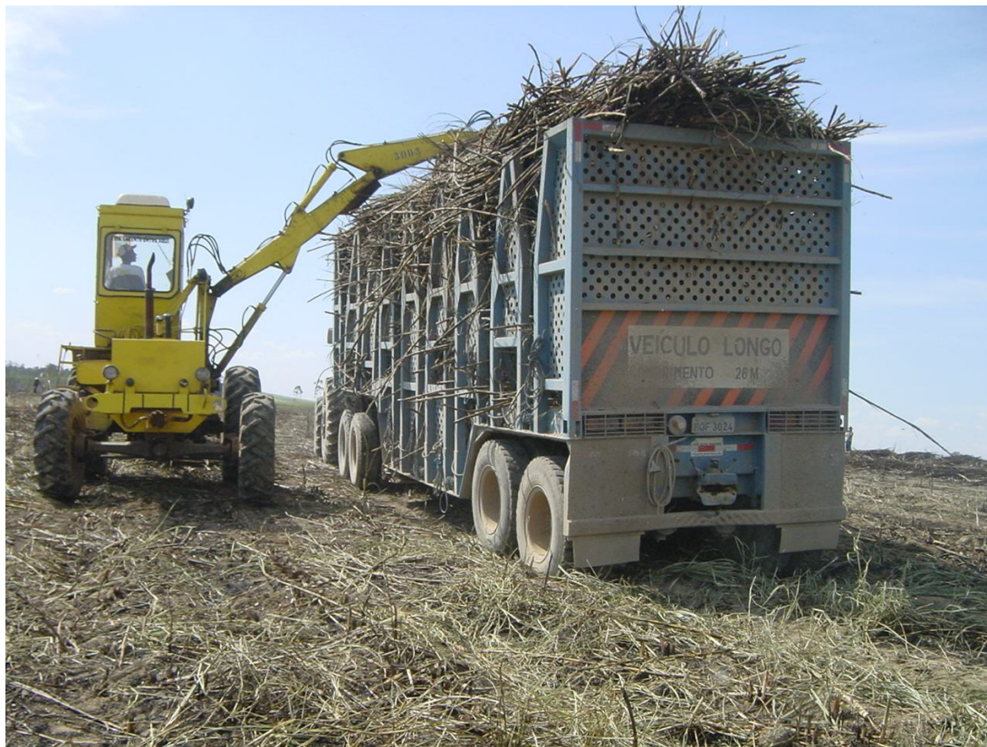
Figura 53: Carregadeira colocando a cana apanhada na Julieta.
