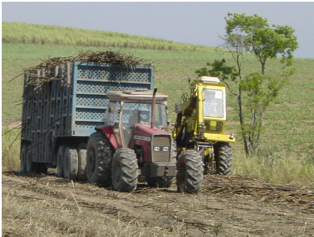
Figura 50: Rebocador com Julieta, acompanhando carregadeira.
