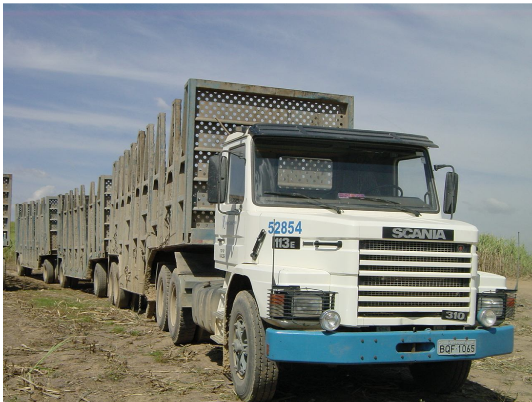
Figura 46: Rodotrem transportando Julietas vazias para a frente de corte. Este tipo de Julieta é apropriada para o transporte da cana inteira.
