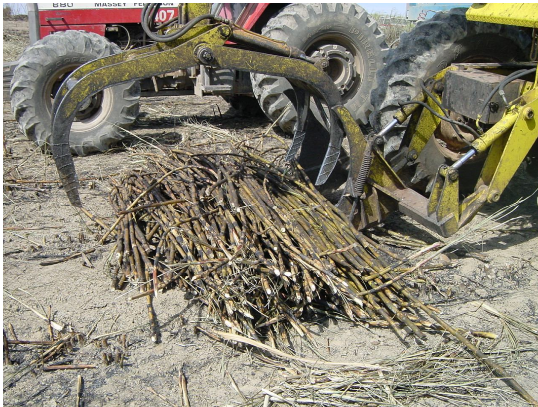
Figura 51: Carregadeira empilhando e colhendo a leira (cana empilhada).
