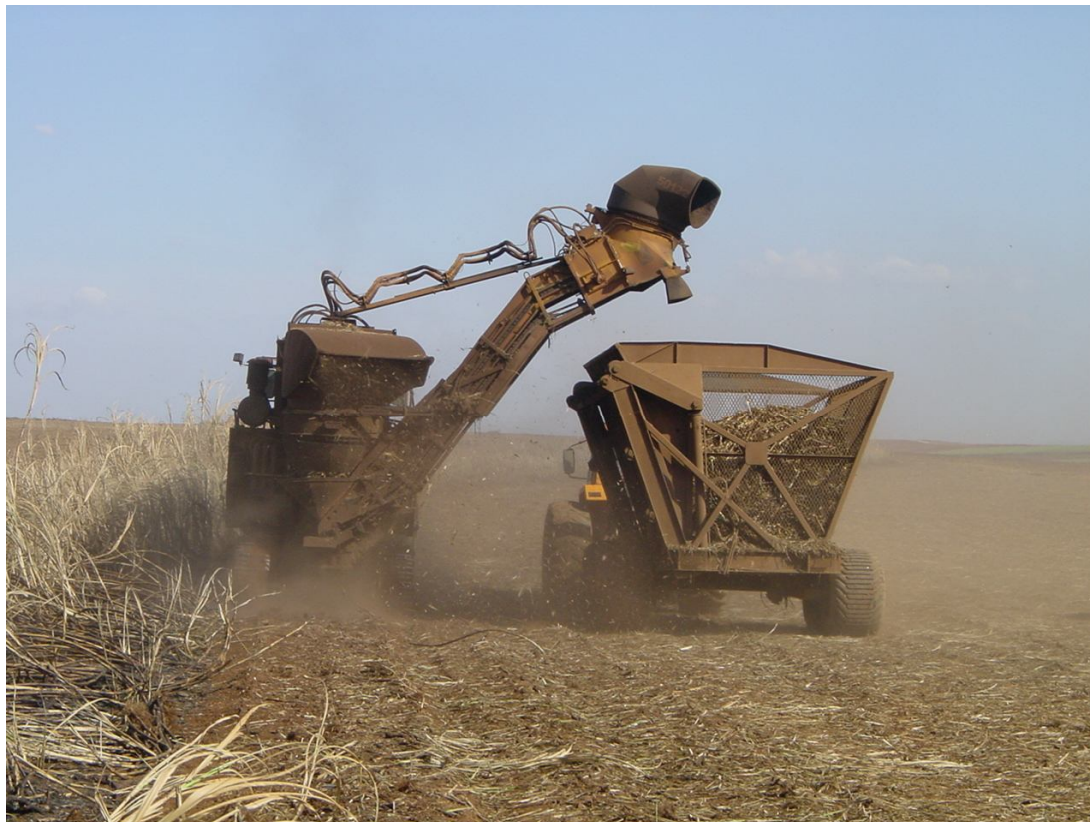
Figura 59: Rebecador com transbordo acompanhando colhedeira mecanizada (traseira).
