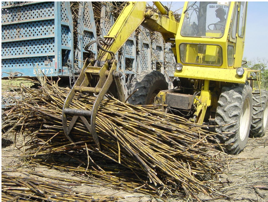
Figura 52: Carregadeira com a GARRA fechada e a leira de cana aprisionada.
