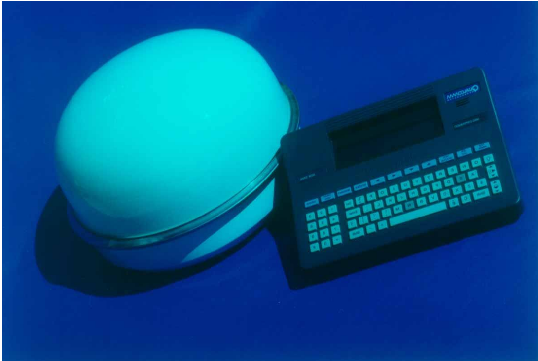
Figura 4: A figura da esquerda, representa a cápsula protetora fabricada em Kevlar que abriga em seu interior a antena e o sistema GPS. A figura da direita, representa o computador de bordo, com teclado e visor reduzido.
