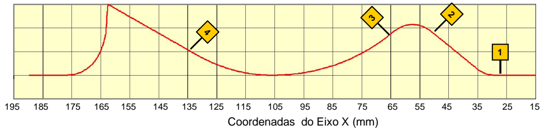
Figura 5.33: Regiões de verificação do aspecto superficial.
