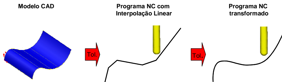
Figura 2.54: Processo de geração de uma interpolação indireta.
