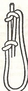
LAÇADA CORREDIÇA — pode ser aumentada ou diminuída conforme seja necessária. Usa-se como esticador para armar toldos ou barracas.
