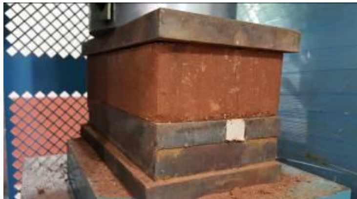
Figura 18 – Ensaio de resistência à compressão em prensa do tijolo M08.
