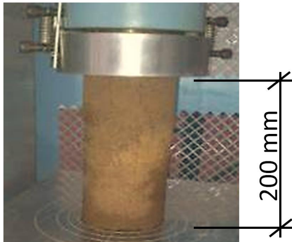
Figura 10 - Corpos de prova cilíndricos submetidos a ensaio de compressão.
