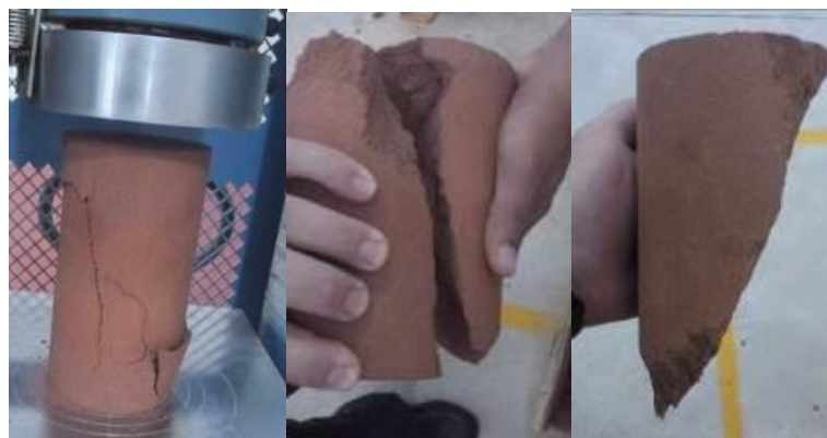
Figura 15 - Rompimento do corpo de prova.
