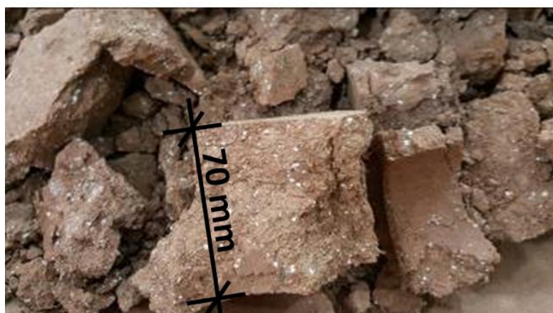
Figura 23 - Tijolo com traço MM 03 após teste de rompimento.
