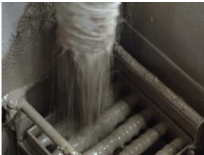
Figura 34: Barbotina passando pela peneira e separador magnético
