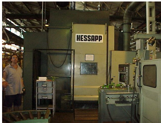
FIGURA 36 – TORNO VERTICAL HESSAPP.
