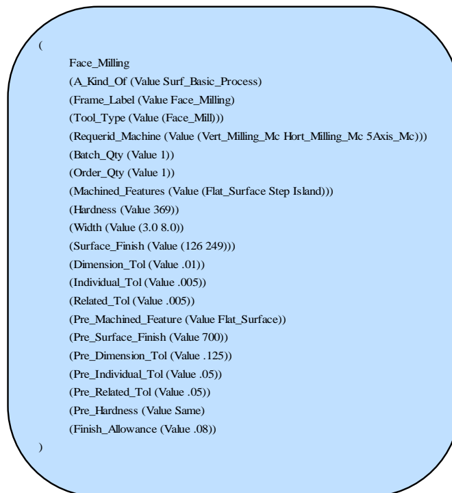
FIGURA 7 – QUADRO PARA UMA OPERAÇÃO DE FRESAMENTO. FONTE: CHANG (1990. P. 17).
