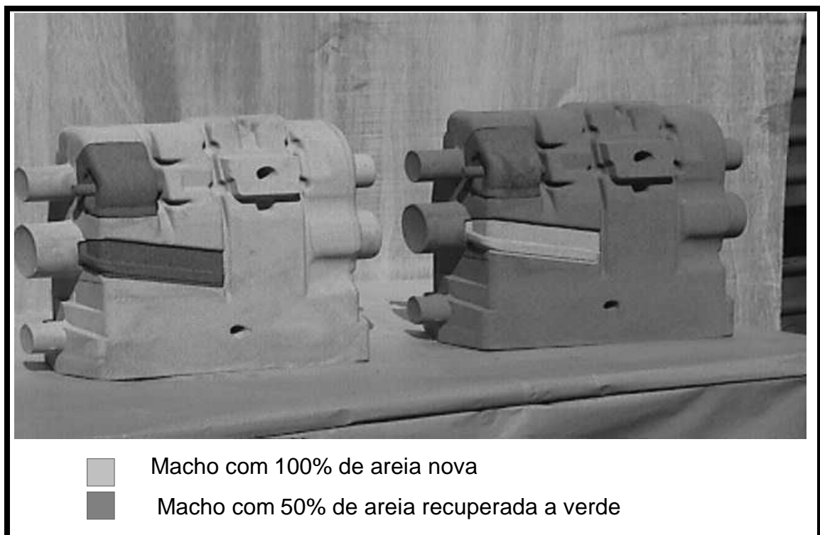
Figura 26 – Machos confeccionados pelo processo cold box com areia nova e com areia a verde (sintética) recuperada.
