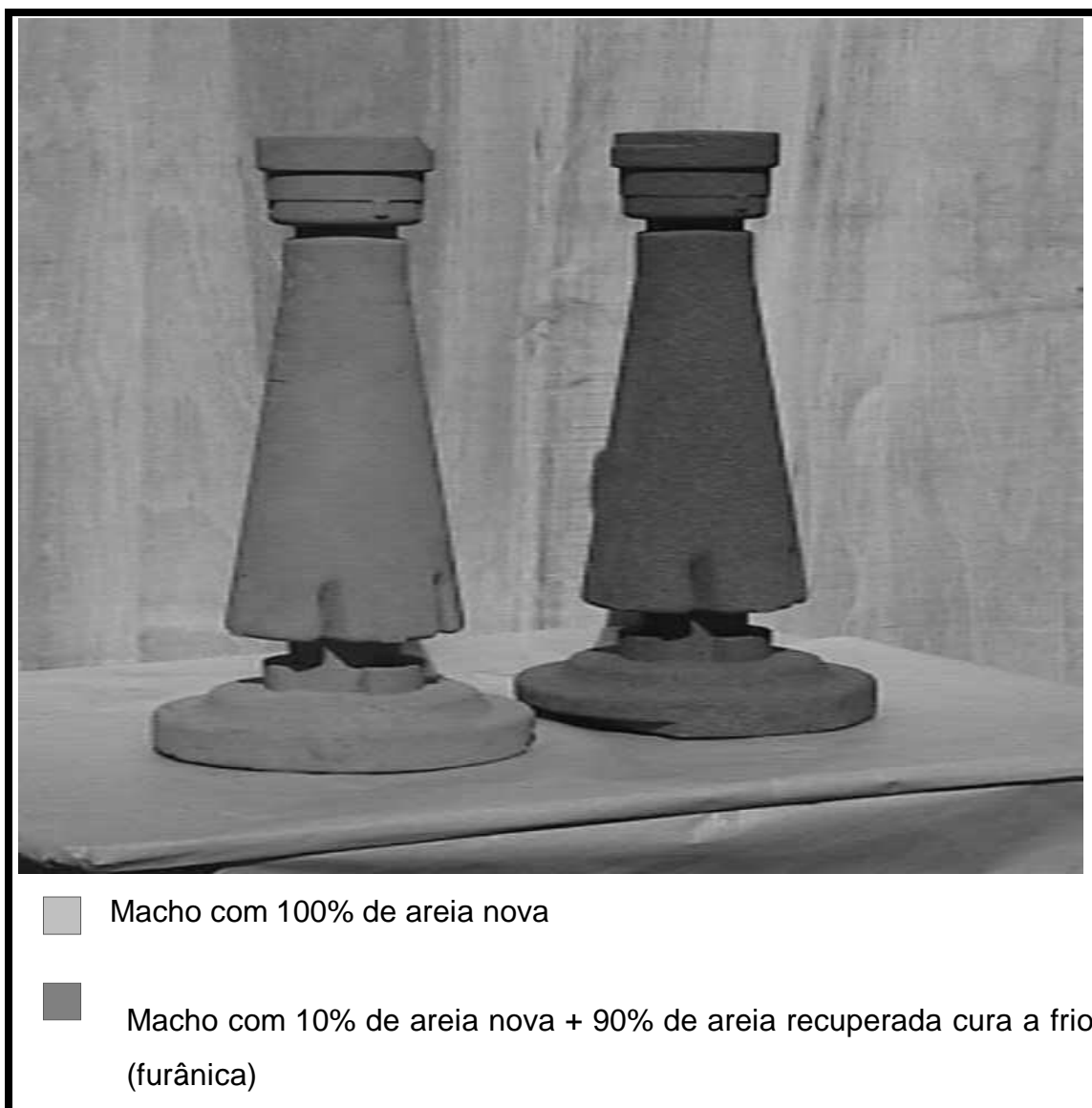
Figura 34 – Machos fabricados pelo processo cold box empregando 100% de areia nova (à esquerda na foto) e com 90% de areia recuperada
