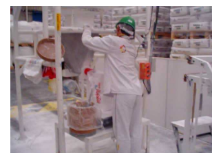
Foto 6 - Martelada para desobstrução do fluxo.
