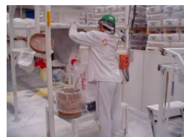
Foto 6 – Martelada para desobstrução do fluxo.
