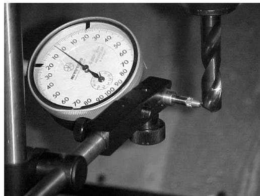
FIGURA 13: VERIFICAÇÃO DE POSICIONAMENTO DA FERRAMENTA
