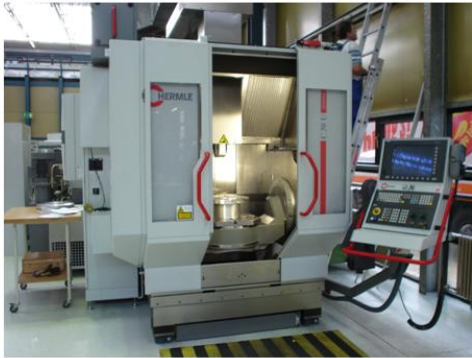
Figura 4.23: Centro de usinagem Hermle C30U Dynamic.
