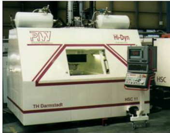
Figura 4.22: Centro de usinagem HiDyn desenvolvido pelo PTW.
