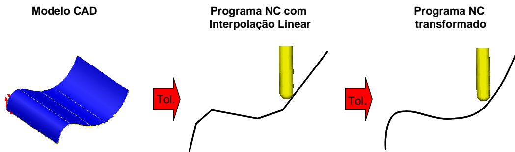
Figura 3.82: Processo de geração de uma interpolação indireta.
