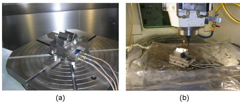
Figura 4.18: Fixação do corpo de prova utilizado nos ensaios.
