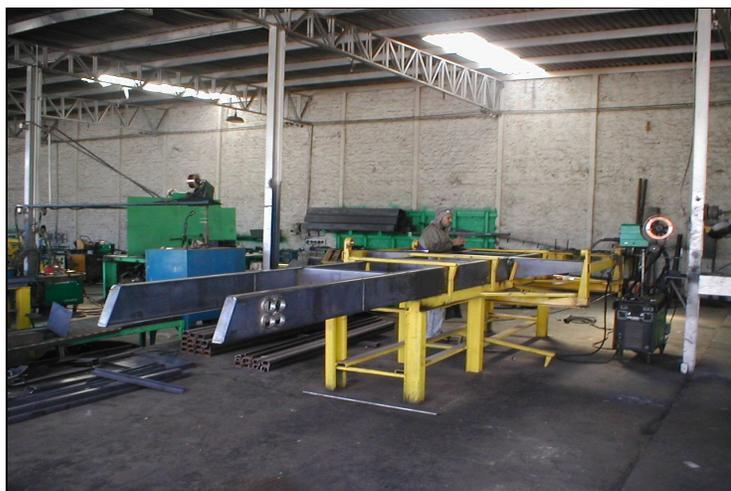
Figura 27 – *Montagem do chassi que se apóia no caminhão*
