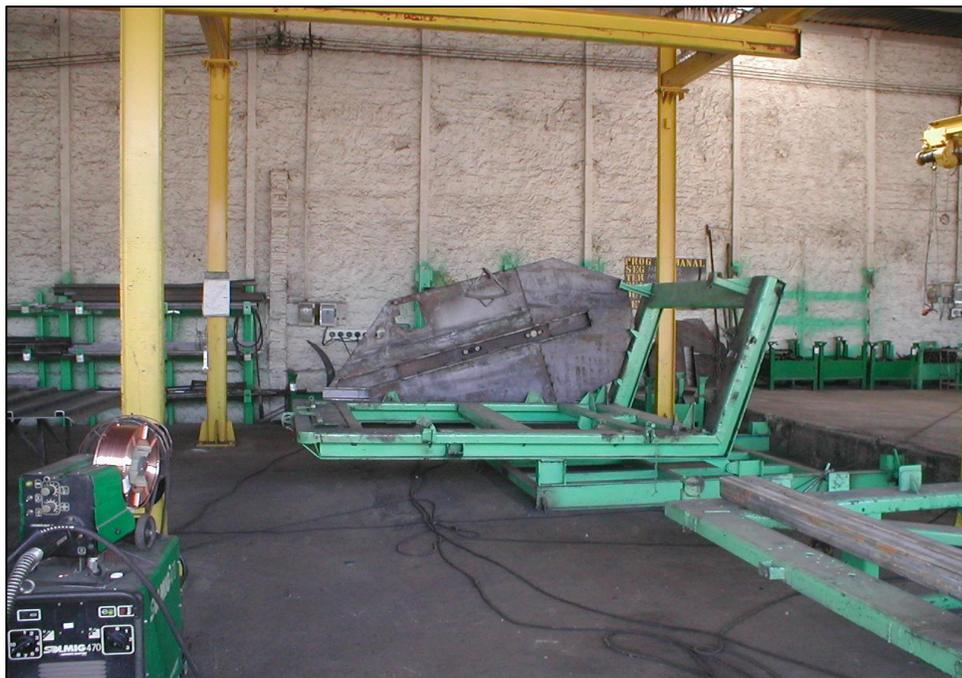
Figura 22 – Montagem das laterais da tampa traseira
