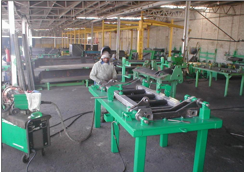
Figura 24 – Montagem da placa compactadora
