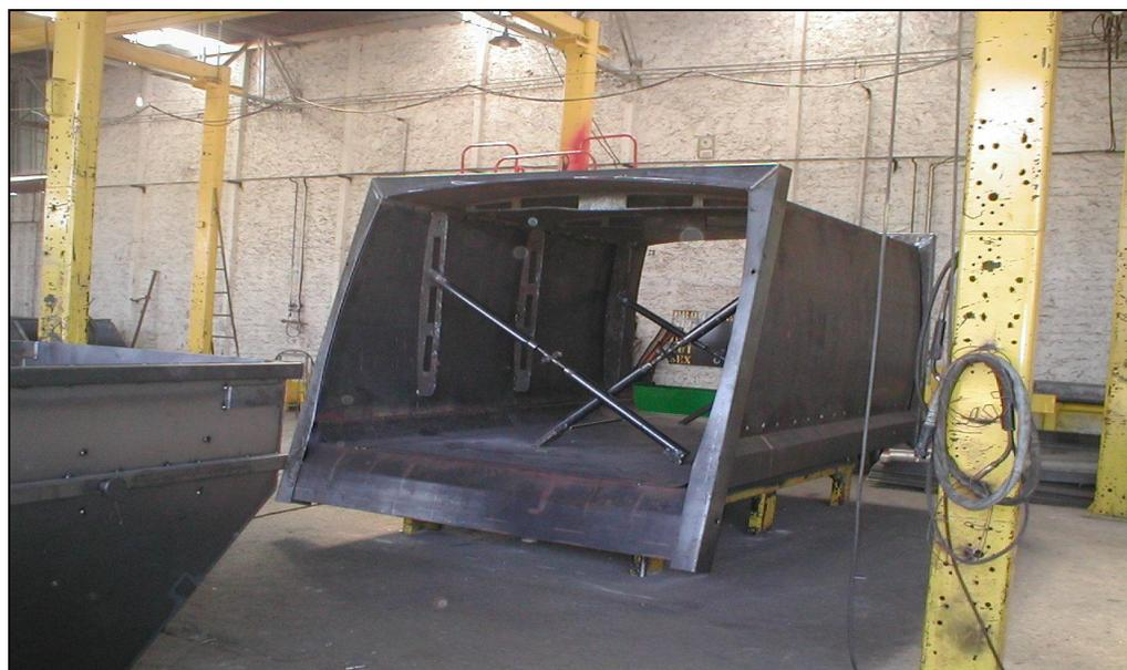
Figura 26 – *Montagem da caixa de carga*
