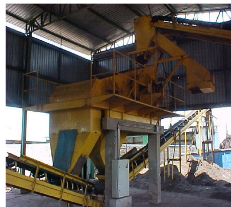
Figura 39 - Entrada do material na peneira Fonte: Bugue Reciclagem
