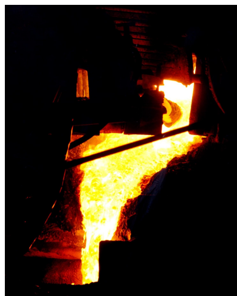
Injeção de Carbofer ® para flotar escória
