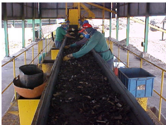
Figura 44 - Esteira para separação de materiais metálicos e não- metálicos Fonte: Bugue Reciclagem
