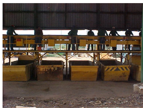
Figura 45 - Caçambas para a separação de material metálico e não- metálico Fonte: Bugue Reciclagem
