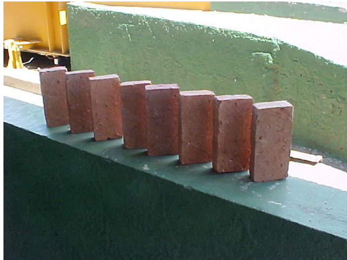
Figura 54 - Proposta para fabricação de tijolos, utilizando-se cerca de 40% de terra da “Shredder” processada Fonte: Bugue Reciclagem
