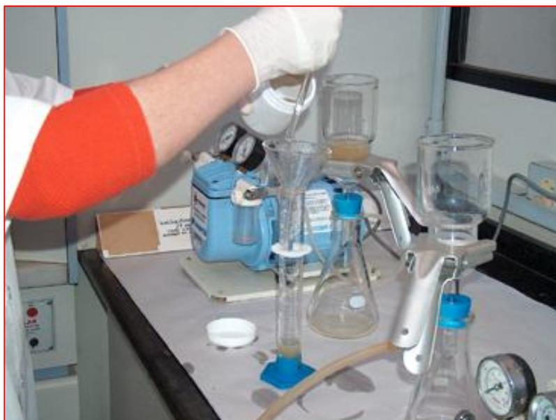
*FIGURA 31- PROCEDIMENTOS PARA FILTRAGEM DO ESGOTO*
