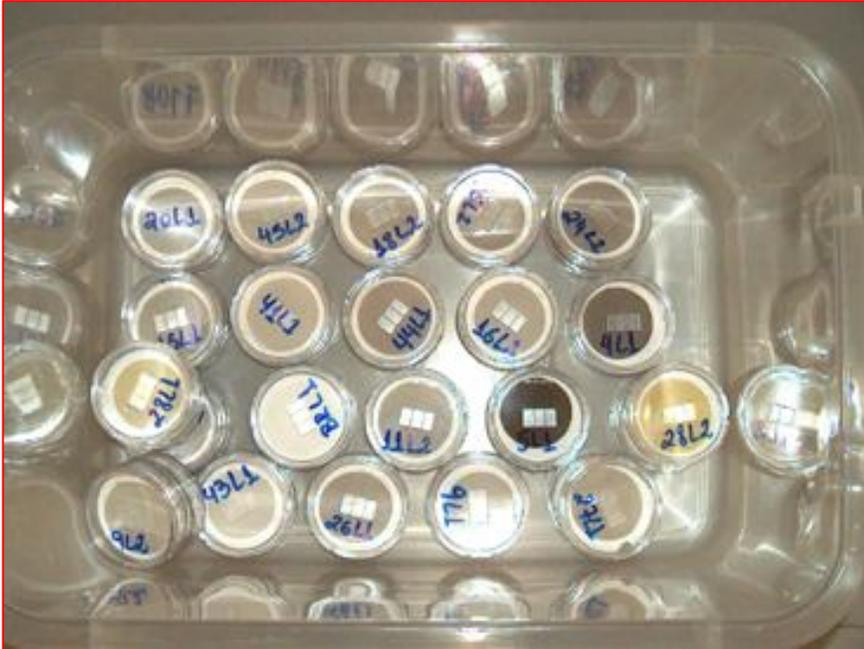
FIGURA 32- FILTROS DE ACETATO PRONTOS PARA ANÁLISE DE FLUORESCÊNCIA ATÔMICA
