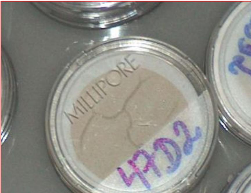
FIGURA 33- FILTRO DE ACETATO COM MATERIAL DE ESGOTO FILTRADO PARA ANÁLISE DE FLUORESCÊNCIA ATÔMICA
