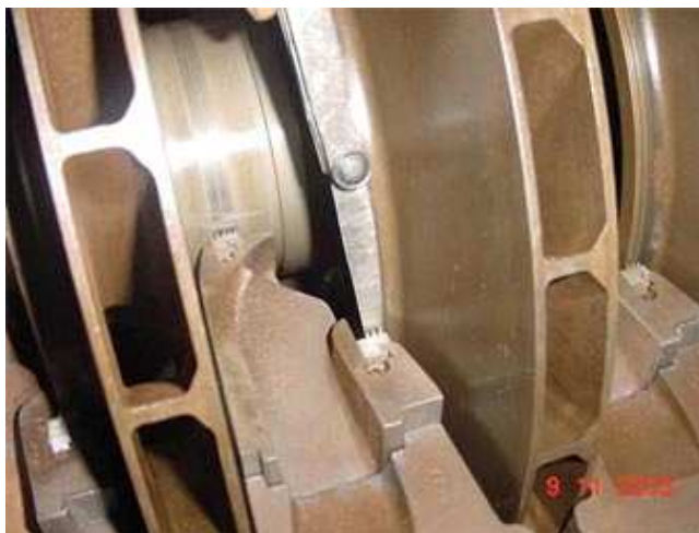
Figura 34. Medição das folgas laterais (NOBREGA, 2005)
