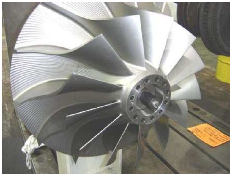
Figura 11. Impelidor usinado tipo semi-aberto (NOBREGA, 2005)
