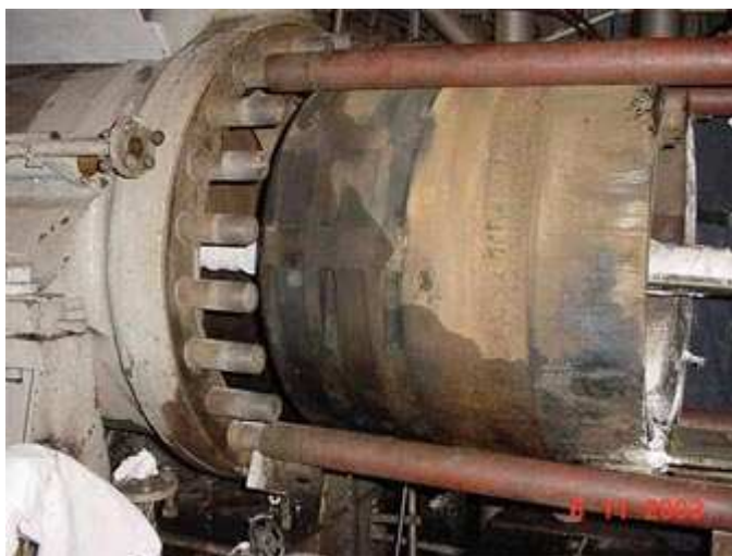
Figura 25. Pacote de diafragmas e rotor ou bundle (NOBREGA, 2005)
