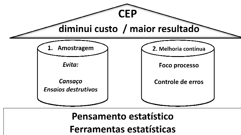
Figura 9– Base e pilares do CEP.
