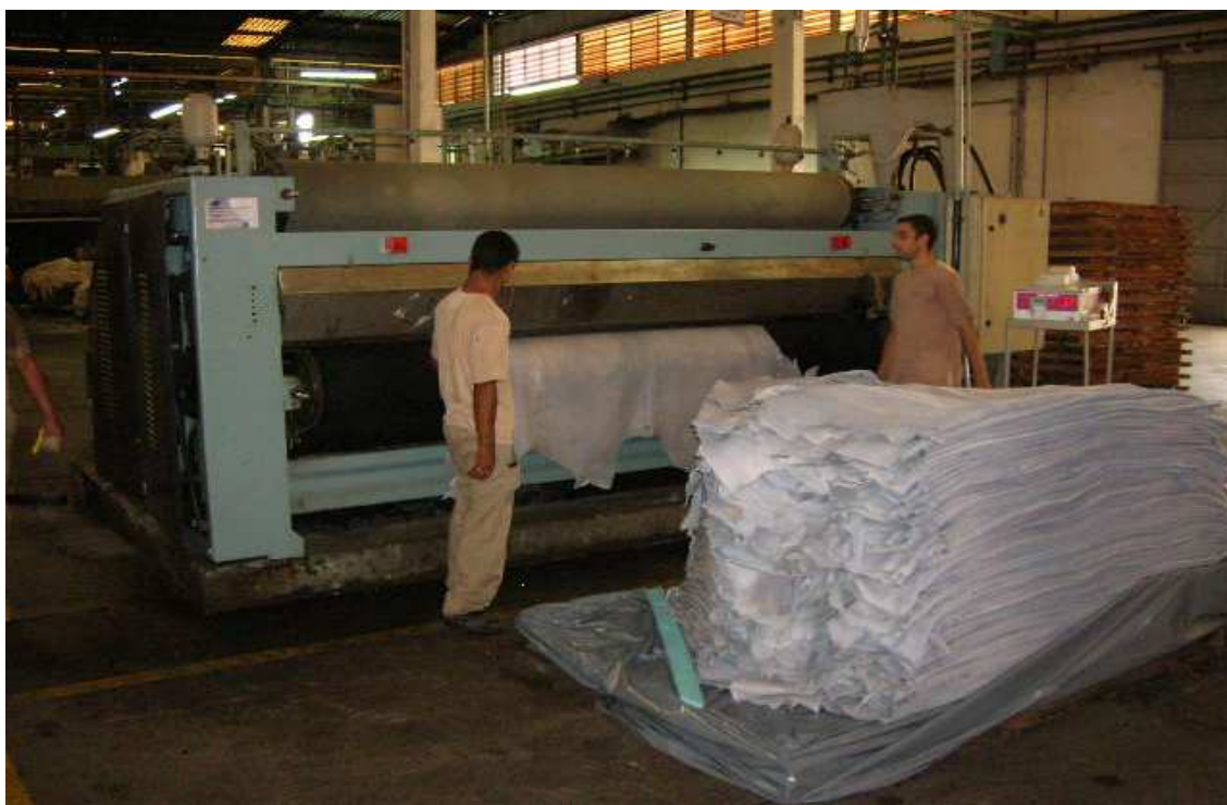
Foto 1: Medição de área com couros wet blue da Empresa A
