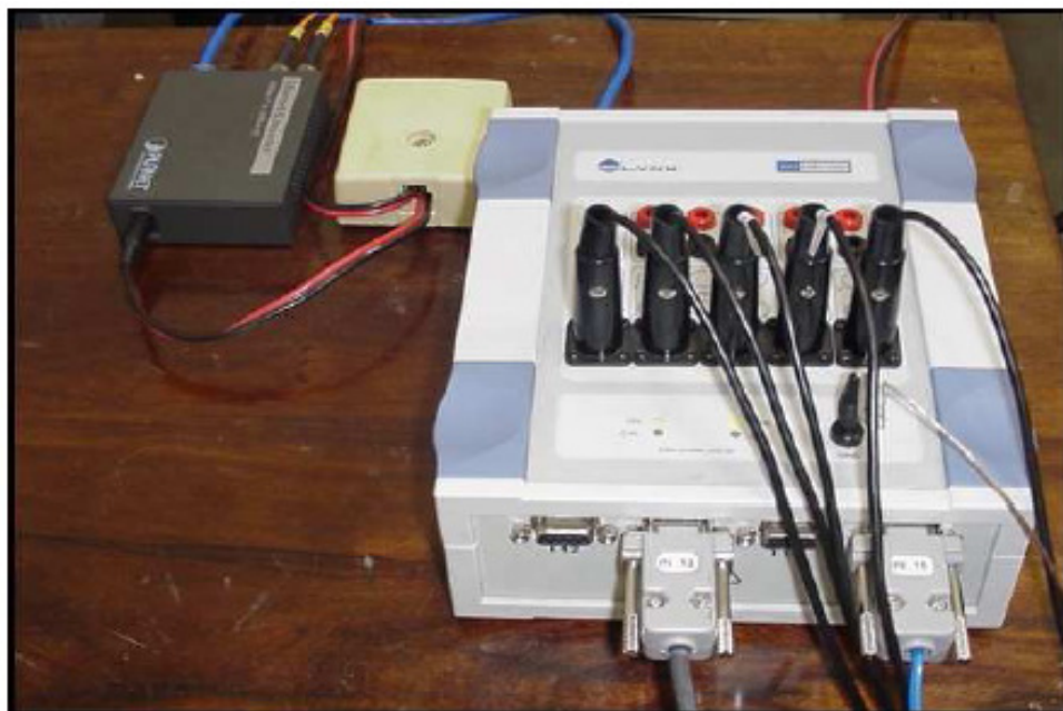
Figura 2 - Módulo de Aquisição de Sinais (MAS) modelo EMG 1000 da Lynx®. Quinze condicionadores de sinais, sendo seis passivos, cinco ativos e quatro para instrumentação.
