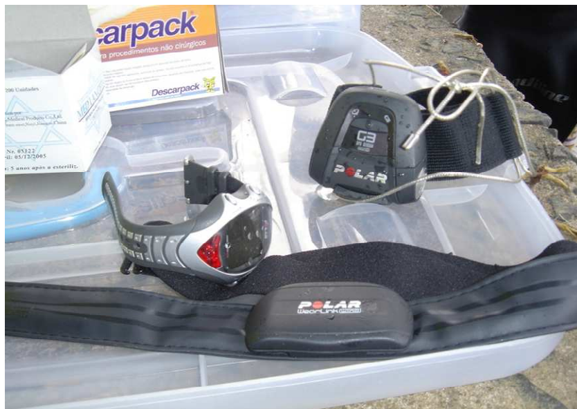
Figura 4: Cardiófrequencímetro e equipamento GPS utilizados para aquisição de dados durante as simulações de prova de canoagem slalom .
