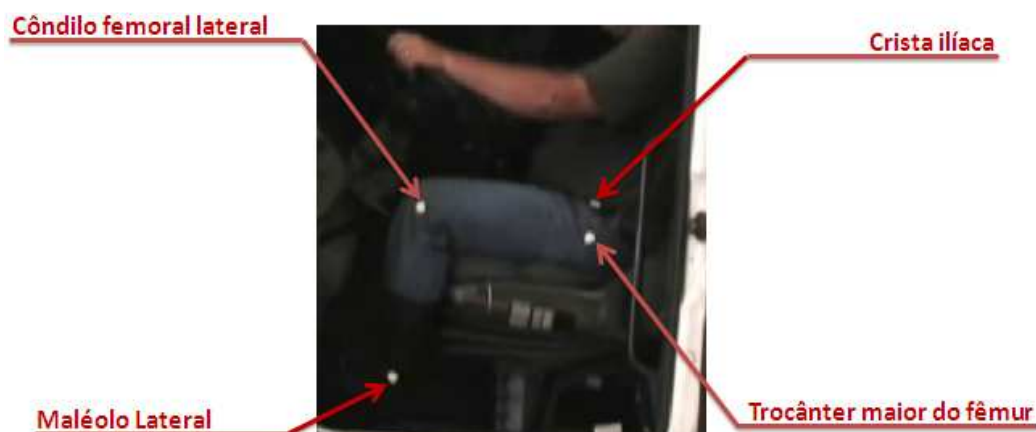
Figura 3 – Fotografia digitalizada indicando os pontos articulares em que foram posicionados os marcadores.
