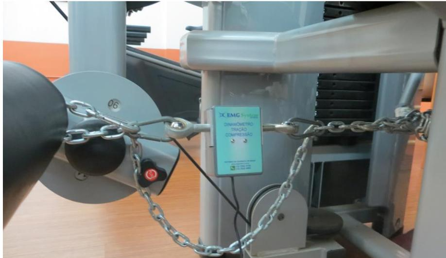
**Figura 7.** Posicionamento da célula de carga no equipamento.
