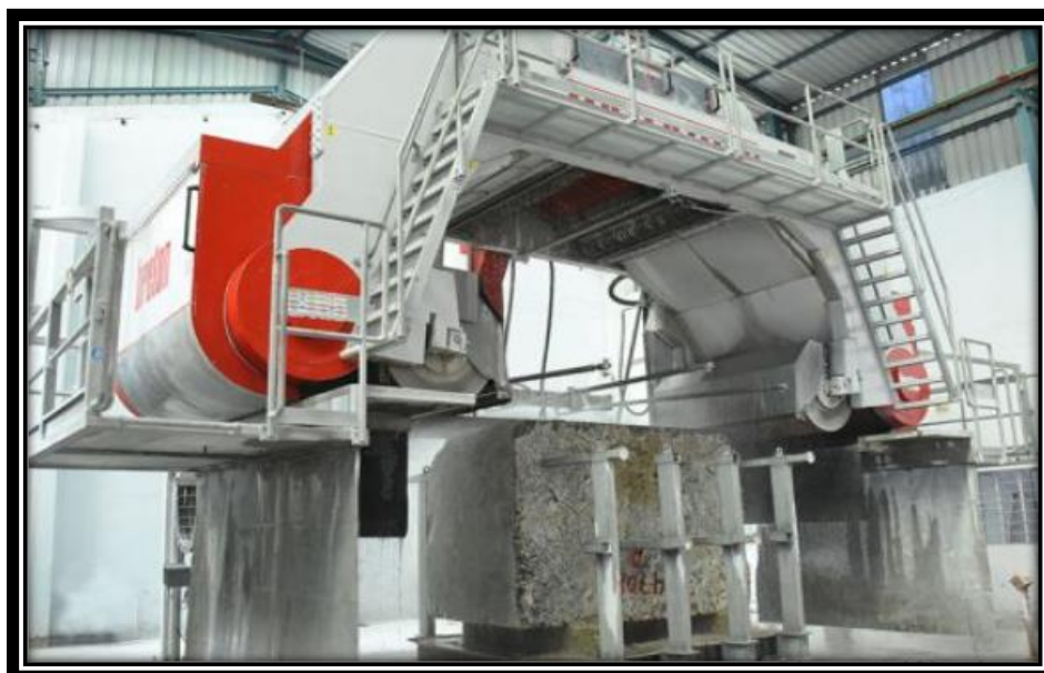
Figura 24 – Tear multifio projetado e fabricado pela BRETON
