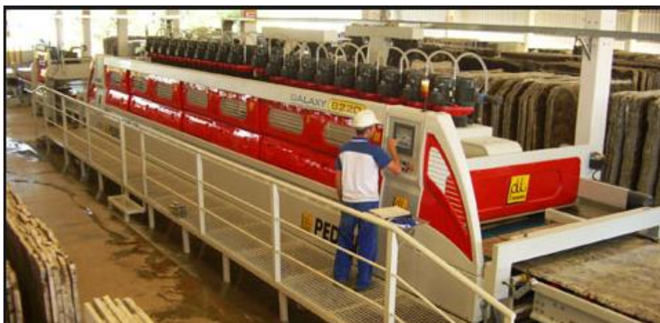
Figura 25 – Politriz automática para mármore e granitos em chapas
