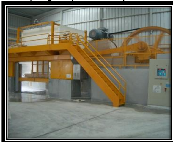
Figura 22 – Teares (Gangsaws) multilâmina para corte de mármore
