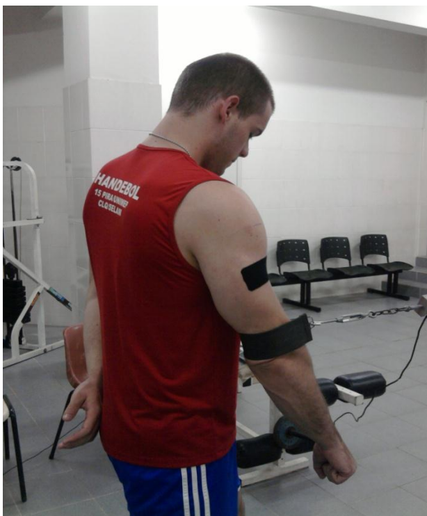
Figura 9 – Posicionamento para coleta da força dos músculos extensores do braço (célula de carga)
