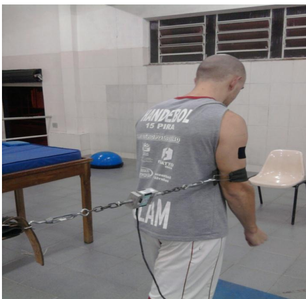
Figura 8 – Posicionamento para coleta da força dos músculos flexores do braço (célula de carga)
