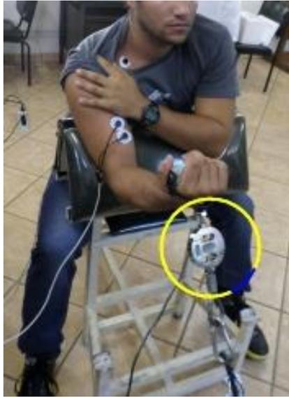
**Figura 4.** Posicionamento da célula de carga.
