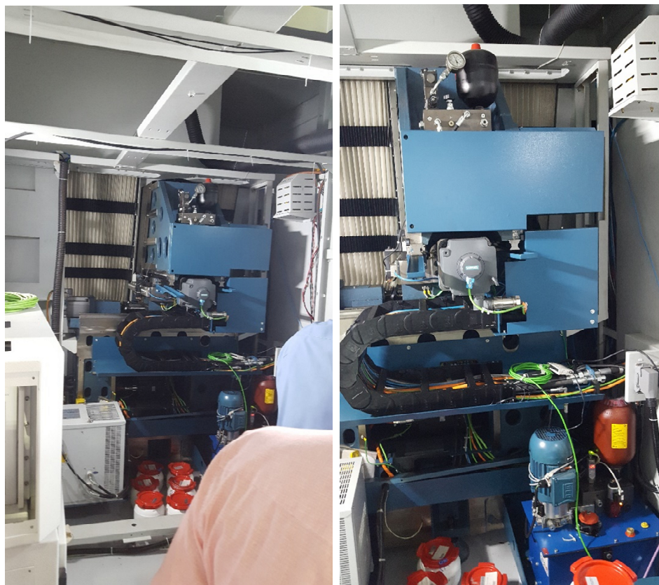
FIGURA 47. MÓDULO DO CABEÇOTE LASER E O CABEÇOTE DE USINAGEM
