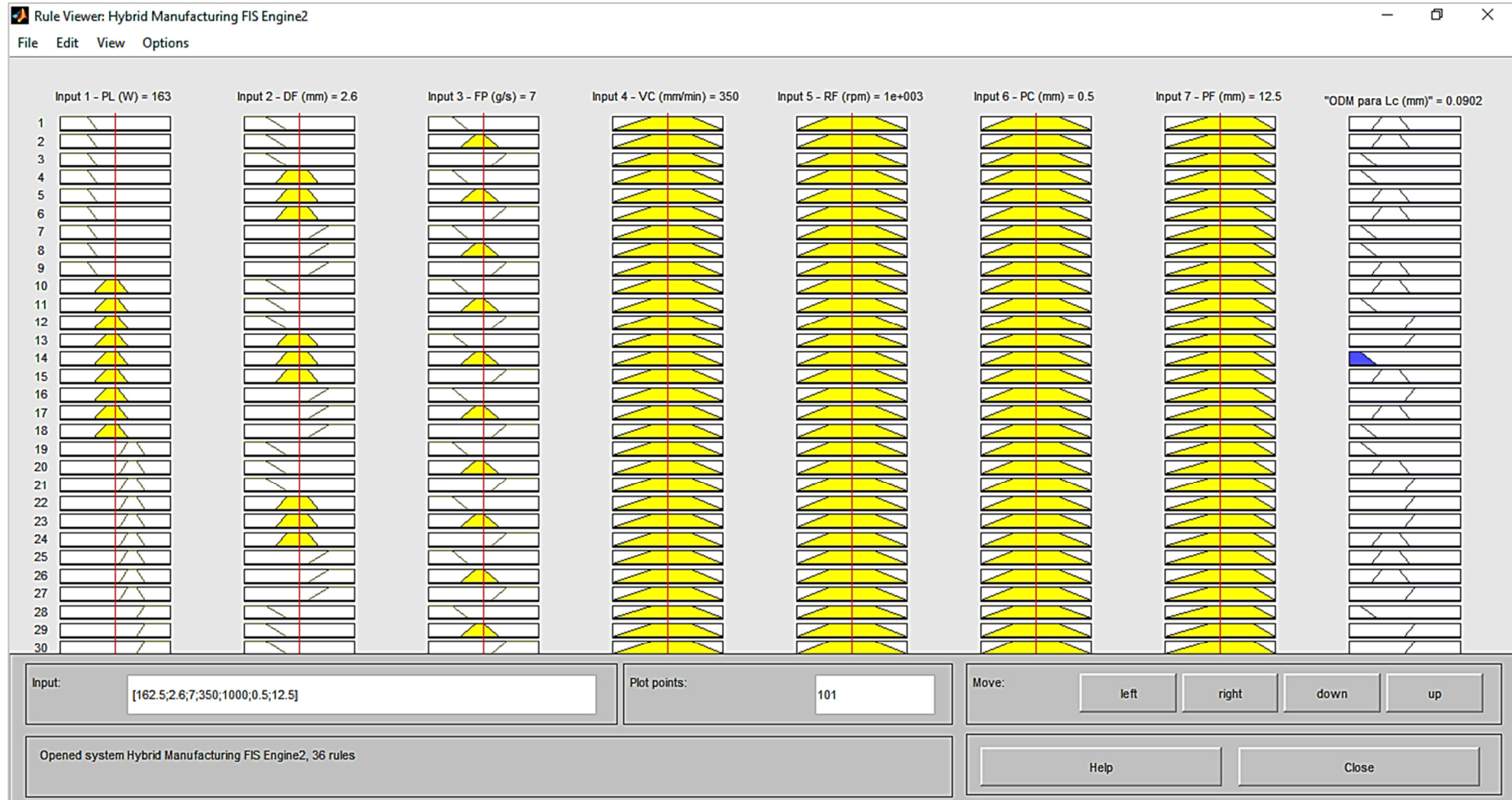
FIGURA 26. VISUALIZADOR DE REGRAS DOS PARÂMETROS DE ENTRADA DO PROCESSO DE MANUFATURA HÍBRIDA PARA A VARIÁVEL SIMULADA Lc
