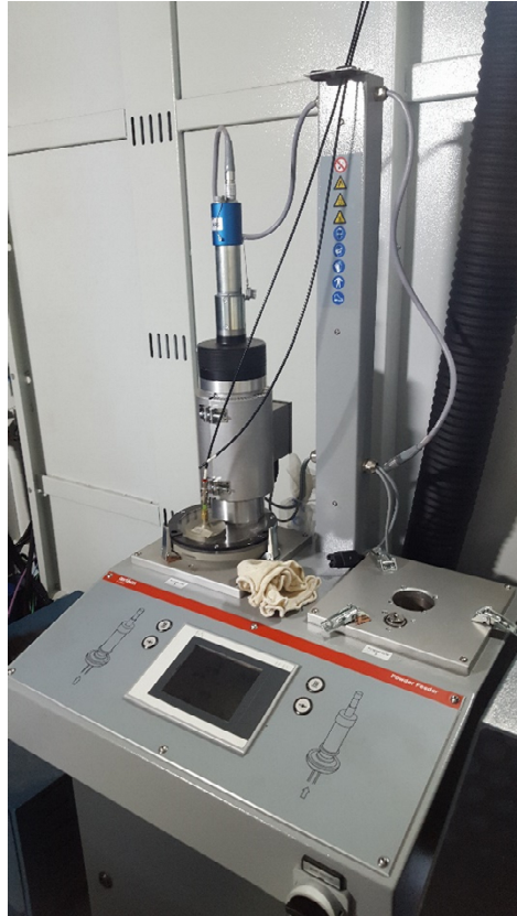
FIGURA 48. MÓDULO DE FORNECIMENTO DO PÓ
